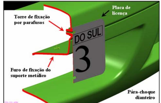
Figura 7.5. Seção do pára-choque dianteiro na região de fixação da placa de licença (GMB, 2005).
