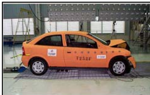
Figura 7.2. Teste de impacto frontal no veículo Astra (referência: GMB).
