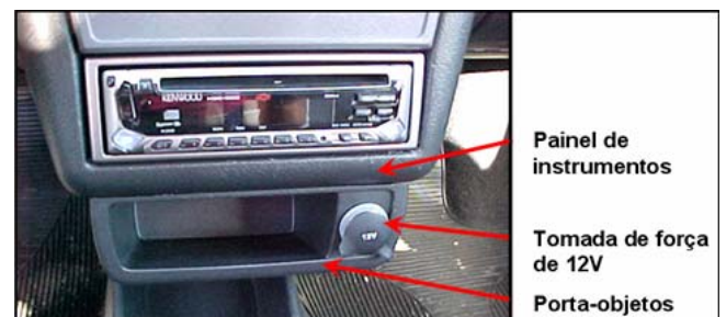
Figura 7.8. Detalhe proposto da tomada de força e porta-objetos.
