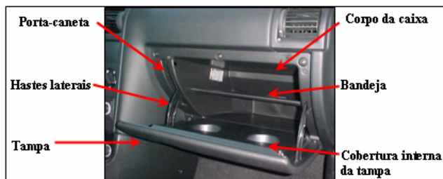
Figura 7.1. Ilustração do conjunto da caixa do porta-luvas e seus principais componentes (referência: GMB).
